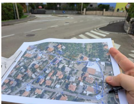
Fotografija lokacije predviđene za izgradnju okna VKO-1 i odnosno kolektora SK-4 na postojeću kanalizijsku cijev s referencom položaja okna na situaciji građevine (položaj je naznačen vrhom kemijske olovke)
